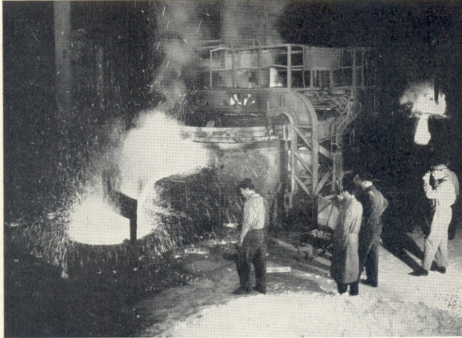
Ferriera dell'Ossola - Acciaieria - Spillata da un forno elettrico ad arco.
